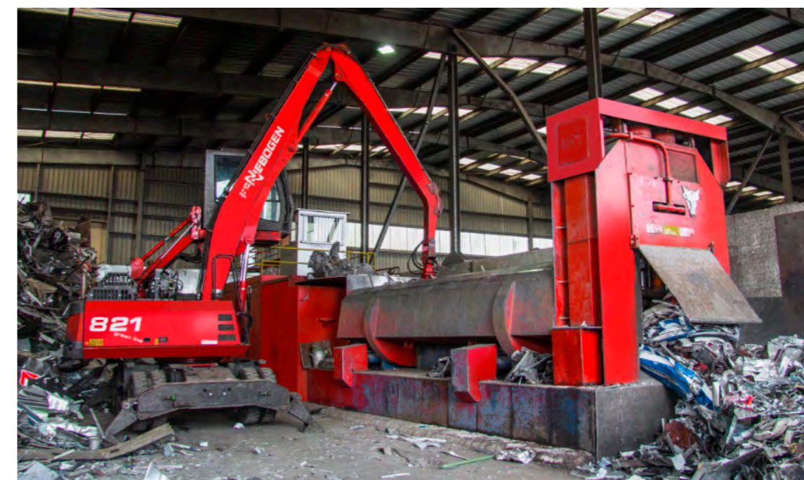
Die Schrottschere bereitet den Schrott durch Zerkleinern chargierfähig auf.
